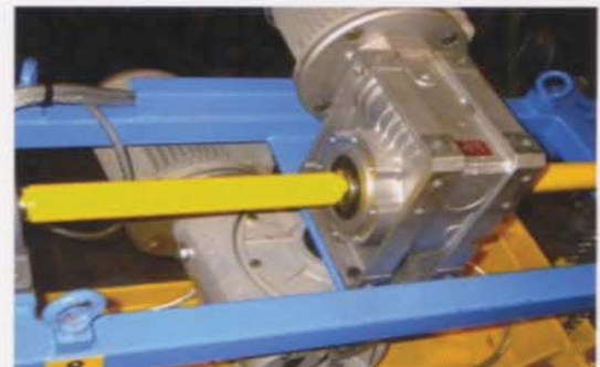
TANK LIFTING GROUP GRUPPO SOLLEVAMENTO VASCA GROUPE DE SOULEVEMENT DE LA CUVE
