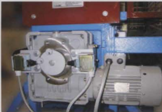
TIP LIMIT SWITCH GRUPPO FINECORSIA RIBALTAMENTO DI MESCOLAZIONE ENSEMBLE DES FINS DE COURSES DE RETOURNEMENT DE LA CUVE
